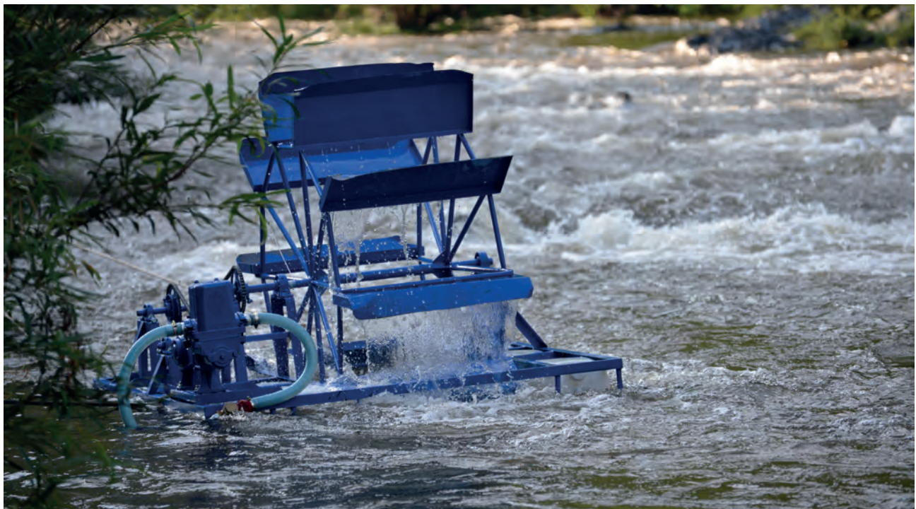
ภาพที่ 1 กังหันพลังน้ำ จุฬา-ปิตทอง 8 (กังหันที่พัฒนารุ่นล่าสุด) ทำการทดลองและติดตั้งบริเวณหน่วยพิทักษ์อุทยานแห่งชาติ ที่ กจ.10 (ห้วยแม่สะเลียง) ที่มา : สุพรรณณี บุญเพ็ญ ถ่ายเมื่อ 25 มีนาคม 2560
