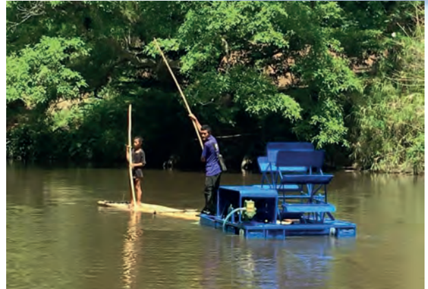
ภาพที่ 3 กังหันพลังน้ำ (จุฬา-ปัตทอง 4) แสดงถึงภูมิปัญญาชาวบ้านในการใช้แพไม้ไผ่เคลื่อนย้ายกังหัน เพื่อไปติดตั้งใช้งานในกลุ่ม ที่มา : สุพรรณิ บุญเพ็ง ถ่ายเมื่อ 20 เมษายน 2559
