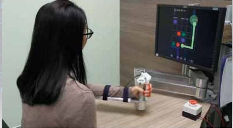
ภาพที่ 6 การใช้หุ่นยนต์ฟื้นฟูแบบจับที่ปลายนิ้วผู้ป่วยโรคหลอดเลือดสมอง ที่มา : วิบูลย์ แสงวีระพันธุ์ศิริ (2560)
