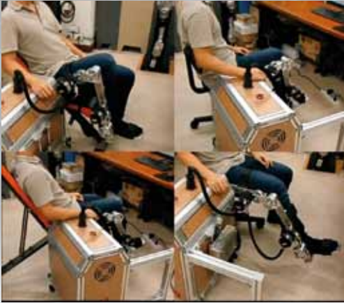
ภาพที่ 5 การทดสอบหุ่นยนต์แบบพื้นฟู ที่มา : วิบูลย์ แสงวีระพันธุ์ศิริ (2560)
