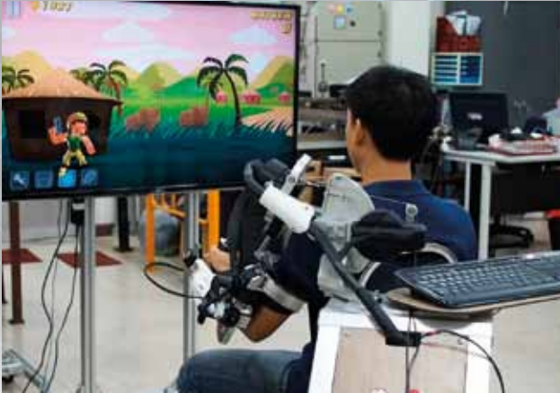
ภาพที่ 8 การทดสอบแขนหุ่นยนต์ CUREs และเกมที่ใช้ฝึก ที่มา : วิบูลย์ แสงวีระพันธุ์ศิริ (2560)
