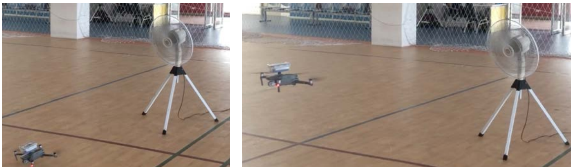
ภาพที่ 5 ระบบเซนเซอร์อากาศติดโดรนที่ผ่านการทดสอบการบินขึ้นลงแม้จะมีลมรบกวน ที่มา : ศรินทร์ นิตินาวรัตน์ ถ่ายเมื่อ พฤษภาคม 2563
