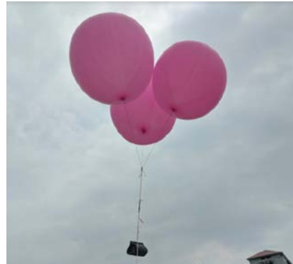
ภาพที่ 1 การติดเซนเซอร์อากาศเข้ากับปลูณและปล่อยขึ้นไปในชั้นบรรยากาศ ที่มา : ศิริินทร์ นิตินาวรัตน์ ถ่ายเมื่อ กันยายน 2562
