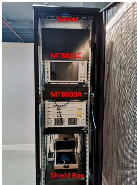
ภาพที่ 10 ชุดอุปกรณ์เครื่องมือวัดในห้องปฏิบัติการวัดทดสอบอุปกรณ์ใช้งานระบบ 5G ที่มา : ภาณุวัฒน์ จันทร์ภักดี และคณะ (2563)
