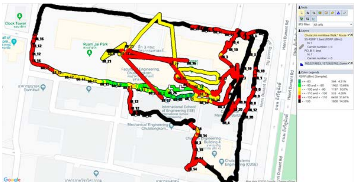
ภาพที่ 7 กำลังของสัญญาณอ้างอิงที่รับได้ (RSRP) สำหรับย่านความถี่ 26 GHz ที่มา : ภาณุวัฒน์ จันทร์ภักดี และคณะ (2563)
