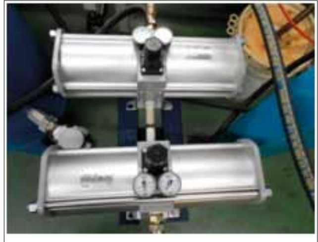
ภาพที่ 6: Pressure Booster ที่มา: ดร. สาธิต เนียมสุวรรณ ถ่ายเมื่อ สิงหาคม 2556
