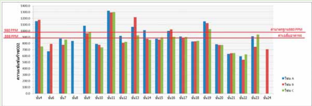
ภาพที่ 2: ค่าความเข้มข้นของคาร์บอนไดออกไซด์ของพื้นที่สำนักงานชั้นต่างๆ และชั้นผู้บริหาร ที่มา: โครงการการออกแบบ (Detail Design) อาคารสำนักงานการไฟฟ้าส่วนภูมิภาคให้เป็นอาคารเขียว (Green Building) เพื่อรับการรับรองมาตรฐาน LEED (2556)
