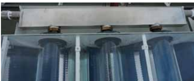
ภาพที่ 4 การเชื่อมต่อท่อแลกเปลี่ยนความร้อนแบบถ่ายเทความร้อนสู่น้ำโดยตรง ซึ่งสามารถเพิ่มประสิทธิภาพการถ่ายเทความร้อนได้สูงกว่าผลิตภัณฑ์แผงรับแสงอาทิตย์ที่อยู่ในท้องตลาด สามารถทำงานภายใต้แรงดันระดับสูง ที่มา : วัฒนา รติสมิทธิ์ ถ่ายเมื่อ ธันวาคม 2558
