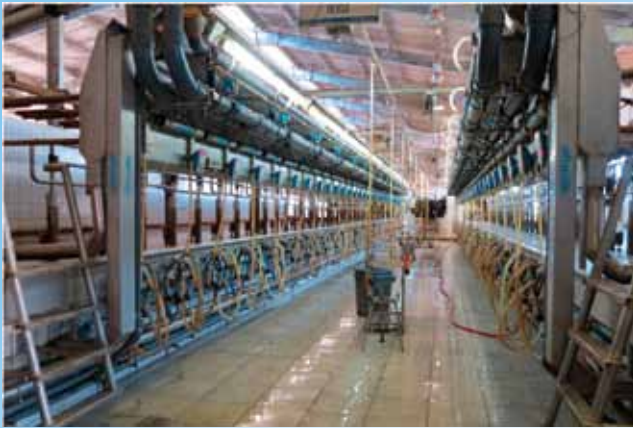
ภาพที่ 9 ระบบเครื่องรีดนมแบบ Pipeline milking system ของฟาร์มโคนมขนาดใหญ่ในประเทศเวียดนาม ที่มา : กิตติศักดิ์ อัจฉริยะขจร (2558)
