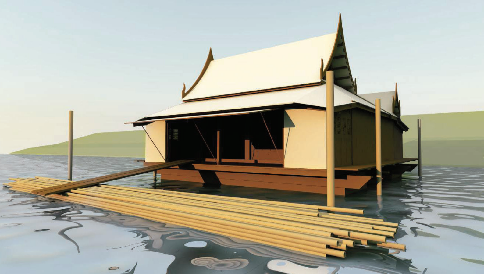
รูปจำลองแสดงส่วนช่วยลอย ประเภทแพลูกบวบไม้ไผ่ซึ่งเป็นรูปแบบที่อยู่อาศัยบริเวณลุ่มแม่น้ำ เจ้าพระยาที่ได้รับการพัฒนามาตั้งแต่อดีตให้มีคุณสมบัติสะท้อนน้ำสะท้อนบก
