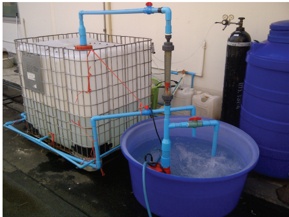
ระบบการทดลองการดักจับก๊าซคาร์บอนไดออกไซด์แบบใช้ความดันและแบบขยายขนาดของ CCC
